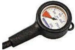
Le manomètre se connecte toujours au premier étage sur une sortie HP. Il mesure la pression relative de la bouteille en Bar. Les pressions inférieures à 50 Bars sont indiquées en rouge (réserve). Certains peuvent être directement connectés à un ordinateur de plongée
